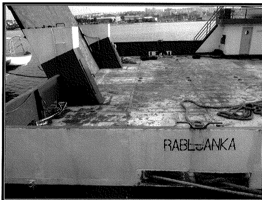
Slika 6. Oštećena paluba
