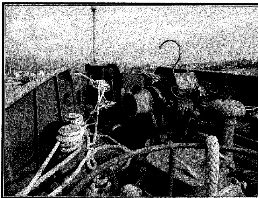
Slika 6. Pramčana paluba sa sidrenim vitlima
